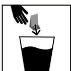
**1** Dilué le produit dans le bac de trempage de 3 à 5% avant passage en machine
